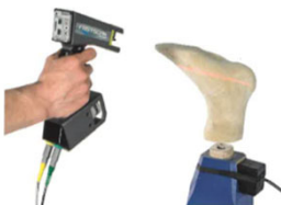
Abb. 12 Scanvorgang eines Leistenpositiv (Fa. Spenle).
